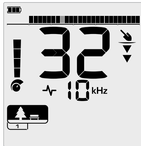
显示探测目标 ID 为 32 的可接受的非铁质金属目标的示例。判别标度上的第 13 段将闪烁,因为该段代表目标 ID 29 到 32。
